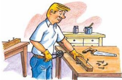
Elimina los elementos metálicos antes de empezar a serrar
