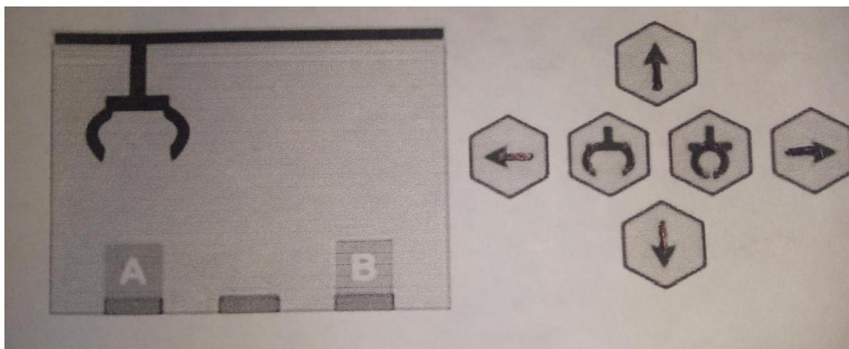
El bulto A esta en la posición izquierda, el bulto B esta en la posición derecha. Los comandos de movimiento de la grúa mueven una sola posición por vez que se accionan. EJEMPLO: Si la grúa quiere desplazarse a la posición donde esta el bulto B el operador debe indicar: derecha, derecha.
