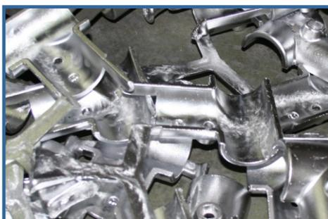
A diferencia de los moldes de arena, los moldes de metal no son porosos, por lo que son necesarios conductos de ventilación para que los gases se dispersen durante el llenado. Además una capa de grafito se aplica al molde para reducir el choque térmico y reducir la velocidad de solidificación.
