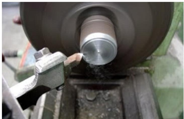
En este caso, la herramienta de corte se desplaza transversal al eje de rotación; gracias al movimiento de giro de la pieza sujeta en el plato giratorio y el avance de la herramienta de corte hacia el centro de la pieza mecanizada se logra obtener un plano preciso en la cara de la pieza.
