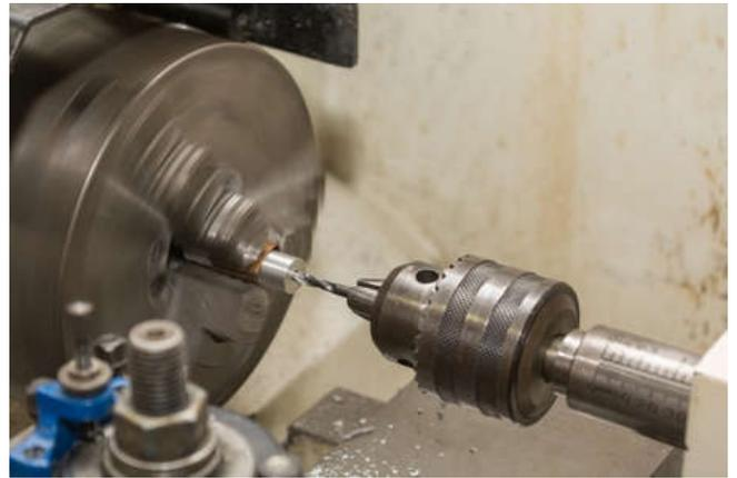
En este caso, es la pieza mecanizada la que gira para producir el arranque de viruta necesario mientras la broca queda fuertemente fijada.
