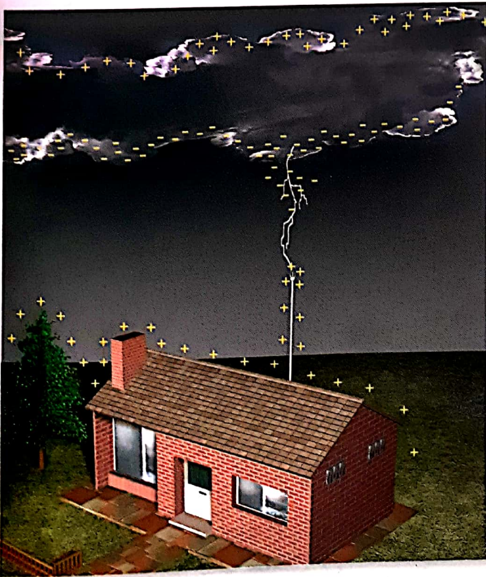
Sobre la base de la electrización y del efecto de puntas podemos explicar el funcionamiento del pararrayos.
