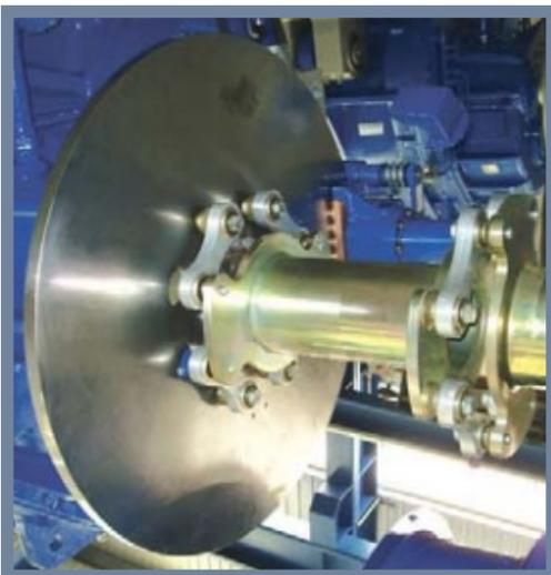
Disco de freno de acero de una aerogenerador.
