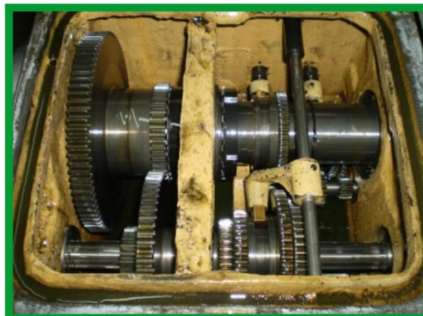
Vista interior de un cabezal fijo
